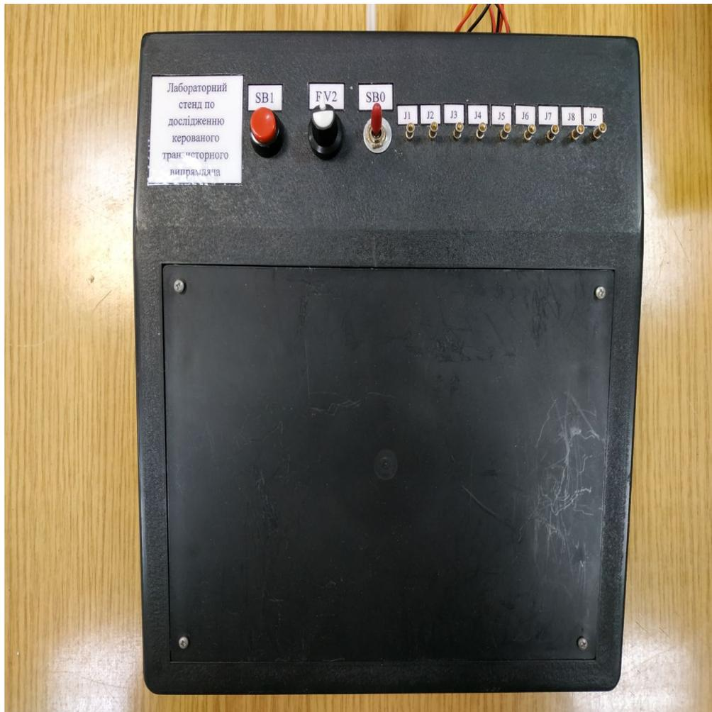
Лабораторний стенд. Дослідження керованого транзисторного випрямляча
