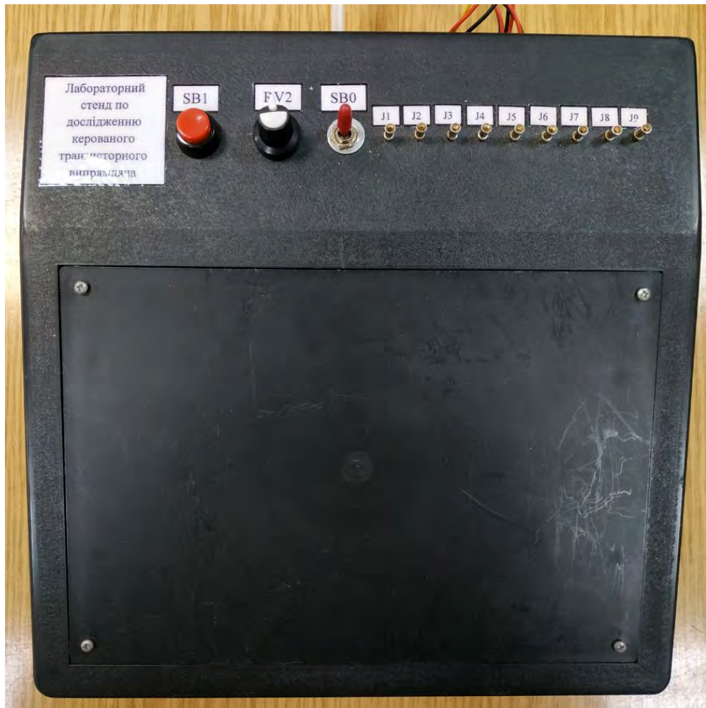
Лабораторний стенд. Дослідження керованого транзисторного випрямляча
