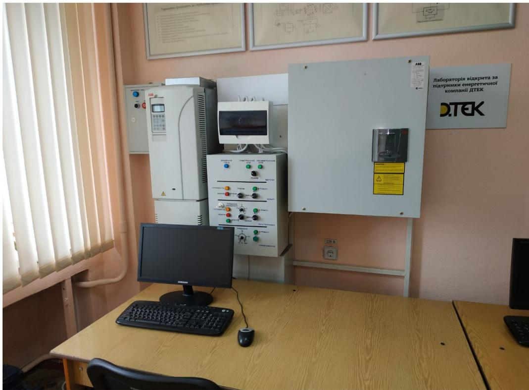
Лабораторний стенд. Дослідження способів підвищення енергетичної ефективності електромеханічних установок при використанні активного фільтру
