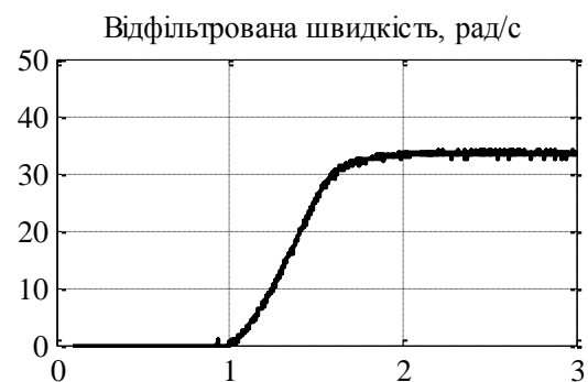
Рисунок 8 – Вихід енкодера та задовільна форма відфільтрованої швидкості
