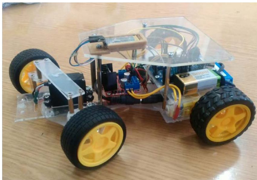
Транспортний робот для дослідження алгоритмів керування рухом розроблений студентами 5-го курсу
