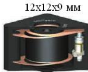
Рисунок 1 – Модель об'єктиву с приводом SQUIGGLE для камери, вбудованої в мобільний телефон.
