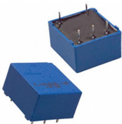
Рис. 3.8. Зовнішній вигляд та основні характеристики датчика напруги LV-25NP (LEM)
